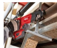
Serra-sabre - WSR para auxiliar o corte dos canais sem gerar faíscas e sem necessidade de energia elétrica
