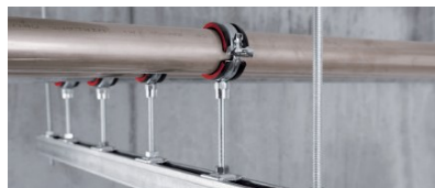
MP-MXI-F abraçadeira galvanizada a fogo com 45 µm, para cargas elevadas com isolamento EPDM e conexão M16
