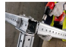
Chave de impacto - SIW, para uma maior produtividade no aperto das conexões sem a necessidade de energia elétrica
